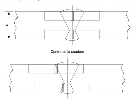
Zone d'altération due à la soudure
