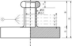
Fig.3 : Cylindre creux en bronze, fermé d'un côté; Plan et coupe verticale, dimensions en mm
