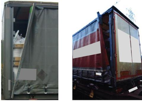
Il controllo alle parti visibili dell'UTI deve essere fatto con attenzione al check-in del Terminal e prima della partenza del treno da parte dell'Impresa Ferroviaria per evitare l'apertura dei teloni scorrevoli durante il viaggio (vedi foto).
