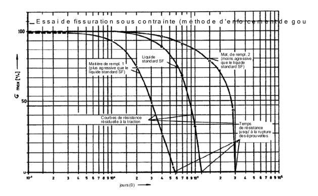
3.3 Procédure pour déterminer le temps de résistance jusqu'à la rupture des éprouvettes
