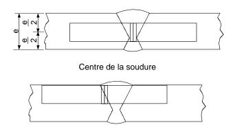
Zone d'altération due à la soudure
